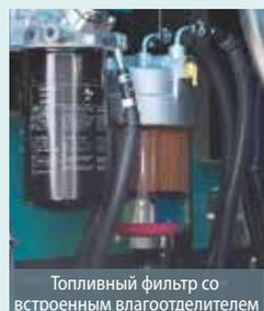
Топливный фильтр со встроенным влагоотделителем
