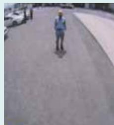
Камера заднего вида устанавливается в стандартном исполнении, что позволяет следить за обстановкой позади машины. Изображение камеры выводится на цветной монитор.
