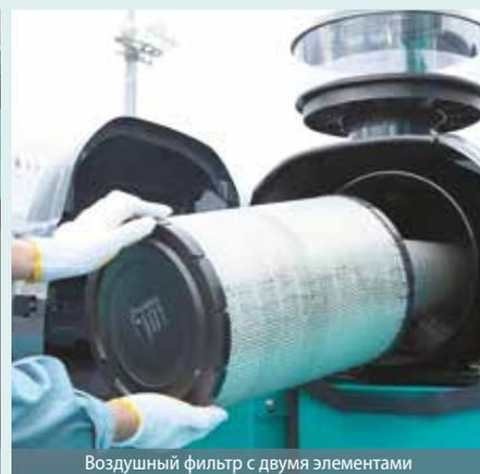
Воздушный фильтр с двумя элементами
