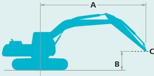
Грузоподъемность при позиционировании рабочего оборудования вдоль продольной оси симметрии ходовой тележки
