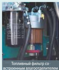
Топливный фильтр со встроенным влагоотделителем
