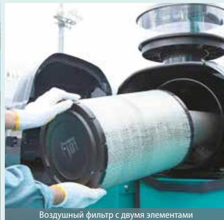
Воздушный фильтр с двумя элементами
