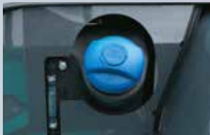
Depósito de urea
