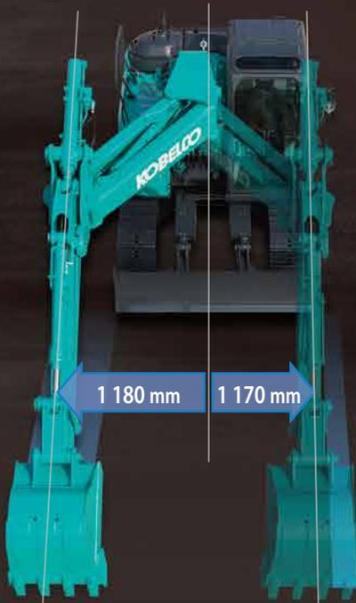
La cinématique exclusive du double déport Kobelco assure une robustesse et une plage de travail inégalées sur le marché. Avec un déport cumulé de 2 350mm, facile de positionner votre godet tout en gardant une visibilité hors normes sur les travaux réalisés.
