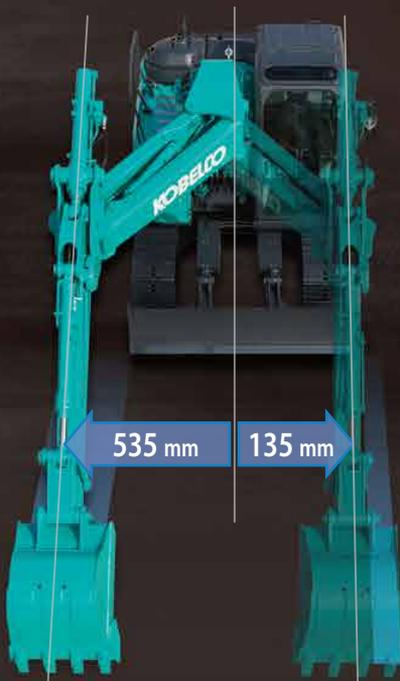
Zur Standardausrüstung gehört ein verstellbarer Ausleger, und ein Planierschild ermöglicht zügige Aushubarbeiten an Wänden oder seitlichen Gräben sowie das Verfüllen.
