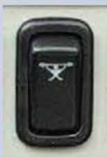
En activant la fonction levage lourd, les pompes hydrauliques délivrent plus de pression et légèrement moins de débit pour plus d'efficacité et de précision lors des phases de manutention délicate.
