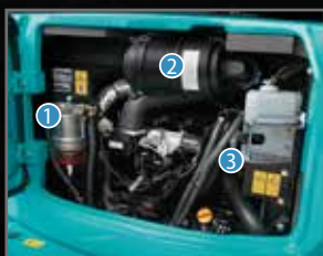
① Préfiltre à carburant avec décanteur d'eau intégré
