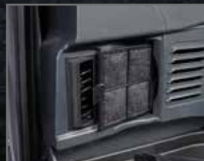
Filtre à air intérieur de climatisation
