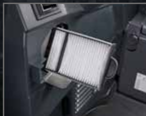
Filtre à air extérieur de climatisation
