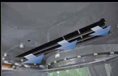
El conducto decalado decelera los gases de escape procedentes del silenciador y el ventilador de refrigeración del motor.
