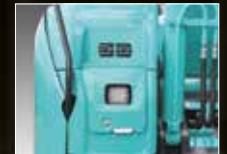
Un projecteur de travail à LED sur la tourelle
