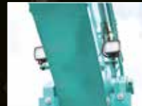
Deux projecteurs de travail à LED sur la flèche
