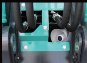
Protection frontale du pied de flèche
