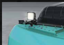
Deux projecteurs de travail à LED sur le contrepoids arrière
