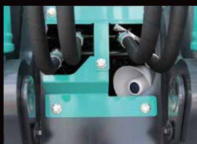
Protection frontale du pied de flèche
