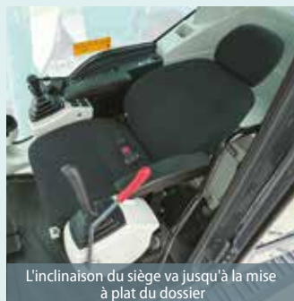
Les doubles glissières offrent un réglage morphologique optimal
