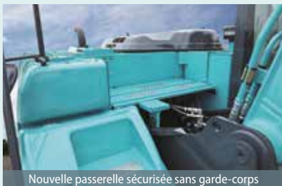
Nouvelle passerelle sécurisée sans garde-corps
