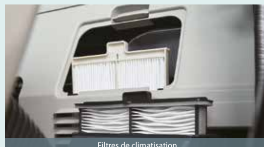
Filtres de climatisation
