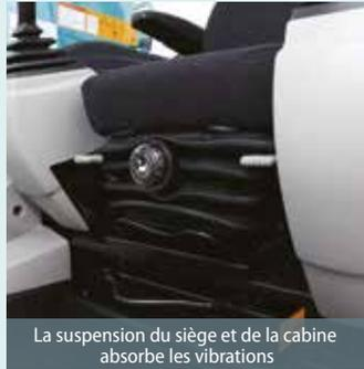
La suspension du siège et de la cabine absorbe les vibrations
