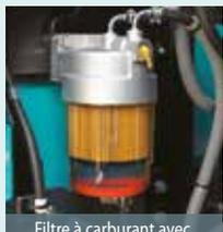
Filtre à carburant avec décanneur d'eau intégré
