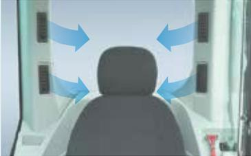
De nouvelles bouches de ventilation et un climatiseur automatique plus performant ont été installés afin d'améliorer la diffusion de l'air conditionnée et harmoniser plus efficacement la température ambiante de la cabine.
