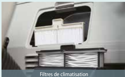
Filtres de climatisation
