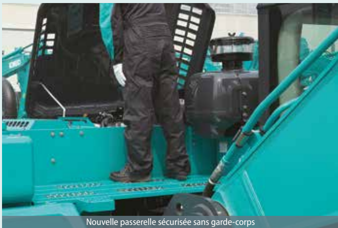
Nouvelle passerelle sécurisée sans garde-corps
