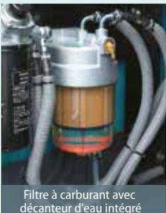
Filtre à carburant avec décanneur d'eau intégré
