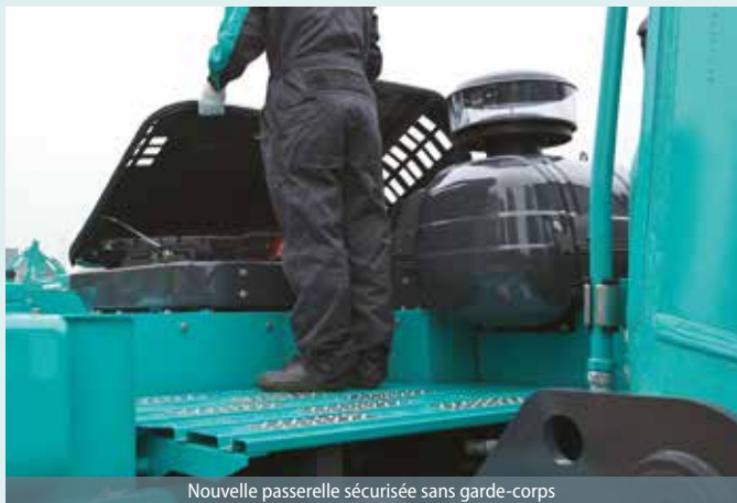
Nouvelle passerelle sécurisée sans garde-corps
