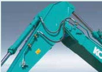
Les lignes hydrauliques auxiliaires sont montées de série.
