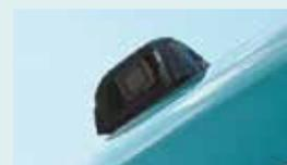
Une caméra de rétrovision peut être installée en option pour sécuriser l'arrière de la pelle d'un simple coup d'œil sur le moniteur.
