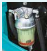
Préfiltre avec décanteur d'eau intégré
