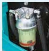
Préfiltre avec décanteur d'eau intégré
