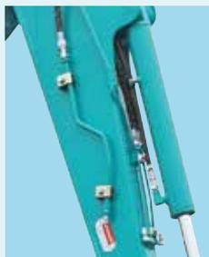
La canalisation hydraulique pour attache rapide est pratique pour le changement d'équipement.
