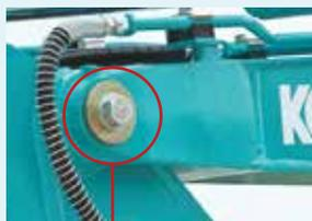
**Axes à verrouillage**
