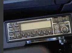
DAB+-Radio (FM/AM & AUX & USB & Bluetooth® & Telefon-Freisprecheinrichtung)
