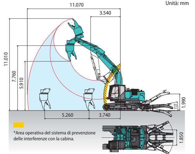
**Macchina per demolizione di auto**
