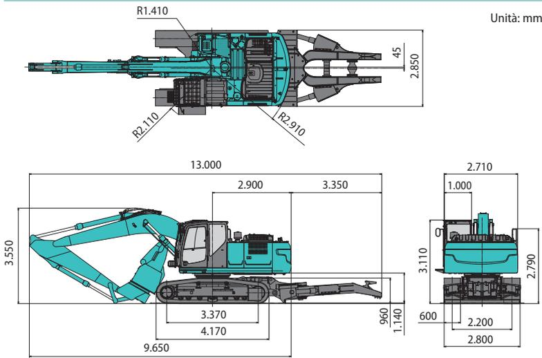
**Macchina per demolizione multifunzione**
