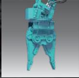
Cesoia per demolizione multifunzione KHE750PR-2 (per SK140SRD)
