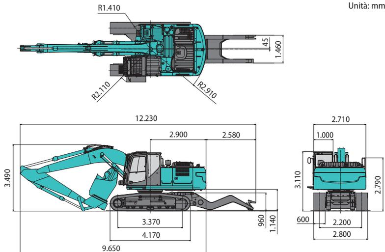
**Macchina per demolizione di auto**
