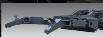
Máquina para multidesmantelamiento (cuatro vías)
