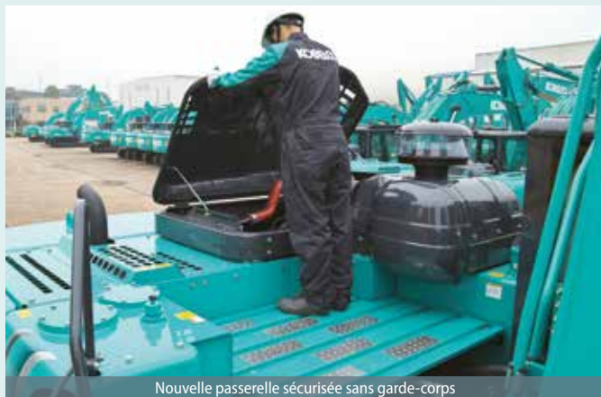
Nouvelle passerelle sécurisée sans garde-corps
