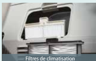
Filtres de climatisation
