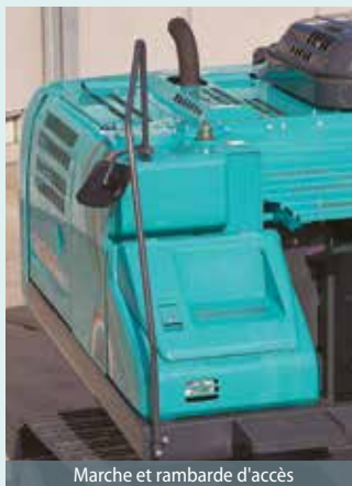
Marche et rambarde d'accès
