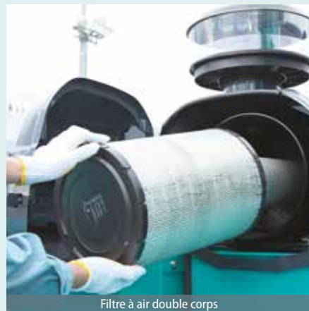
Filtre à air double corps
