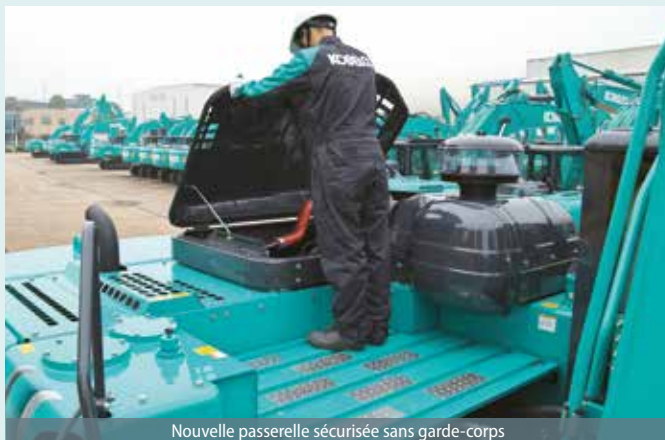
Nouvelle passerelle sécurisée sans garde-corps
