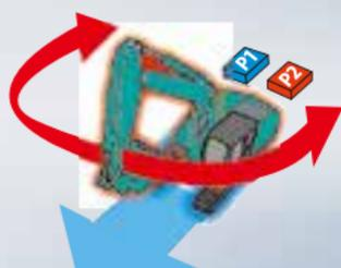
La Traslación Independiente Automática dedica una bomba hidráulica a la traslación y otra al implemento de forma continua, permitiendo una velocidad de desplazamiento suave y constante incluso al rotar o usar el balancín o el implemento. Con Traslación Independiente, la seguridad transportando un gran tubo por una obra es coser y cantar.
