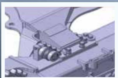
La anchura de la oruga se puede ajustar mediante las posiciones del perno de fijación para cumplir con las regulaciones de transporte.
