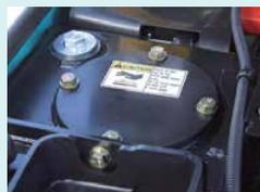
Réservoir d'huile hydraulique
