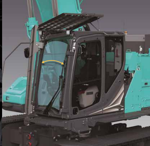
Protection de cabine ouvrable pour nettoyer les vitres
