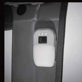
Éclairage de cabine à LED
