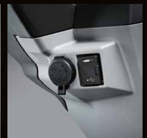
Prise d'alimentation 12 V / Port USB
