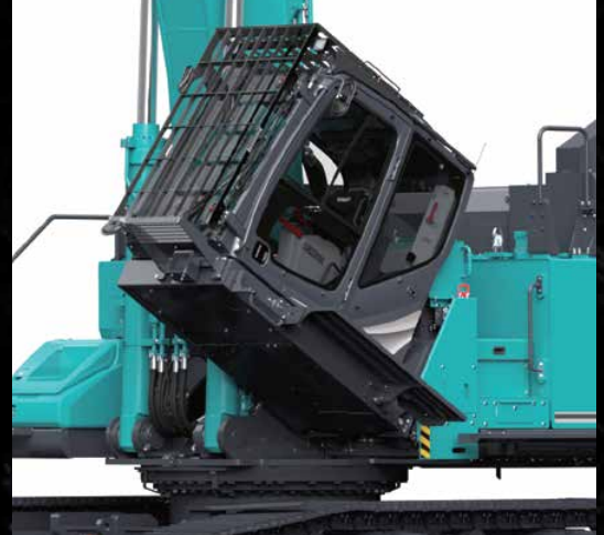
La cabine est inclinable jusqu'à 30°
