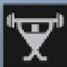
Un'elevata pressione idraulica (Heavy Lift) implica una maggiore potenza di sollevamento, a raggio più corto, consentendo un funzionamento regolare e costante anche per lo spostamento di oggetti pesanti.
