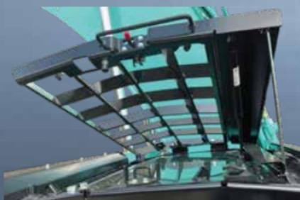
La protezione sul tettuccio standard può essere aperta con un ammortizzatore a gas in posizione inclinata per facilitare la pulizia dei finestrini. Tettuccio protettivo conforme ai requisiti dello standard livello II (ISO 10262).
