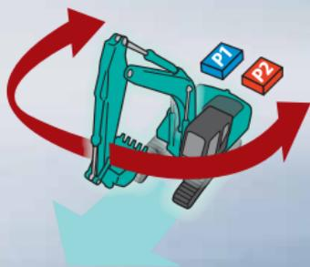
La selezione del sistema di traslazione indipendente permette di dedicare continuamente una pompa idraulica alla traslazione e una all'accessorio, consentendo una velocità di movimento costante e regolare anche durante l'oscillazione o l'uso del braccio o dell'accessorio. Grazie alla traslazione indipendente, il trasporto in sicurezza di un tubo largo in un cantiere è facilissimo.
