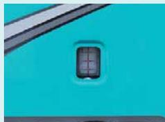
Indicatore del serbatoio dell'olio idraulico
