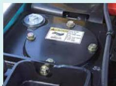
Serbatoio dell'olio idraulico
