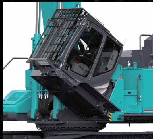
La cabina può essere inclinata fino a 30°
