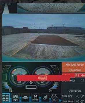
Display di avviso di interferenza con la cabina
