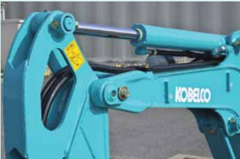
Slangen bakcilinder lopen door graafarm
