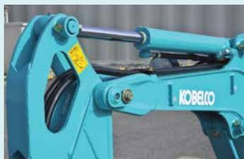
Las mangueras de los cilindros del cazo se tienden dentro del brazo.
