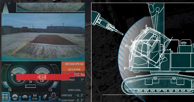
Visualización de advertencia de interferencia con la cabina
