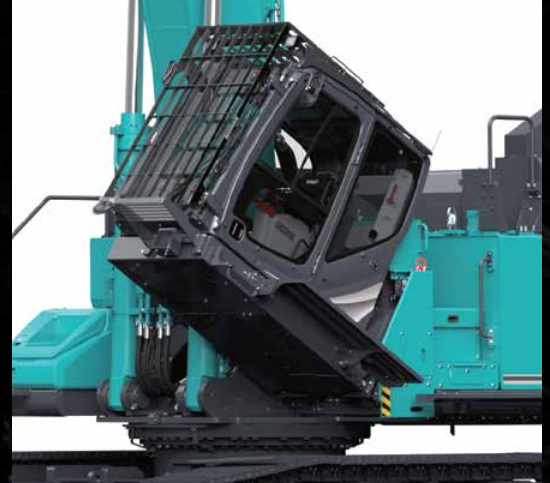
La cabina se puede inclinar hasta 30°
