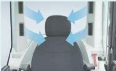
Дефлекторы большого кондиционера воздуха расположены позади сиденья оператора и обдувают сиденье и области по бокам от него. С их помощью можно направить прямой поток прохладного или теплого воздуха на оператора, что позволяет создать комфортную рабочую среду.
