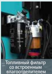
Топливный фильтр со встроенным влагоотделителем
