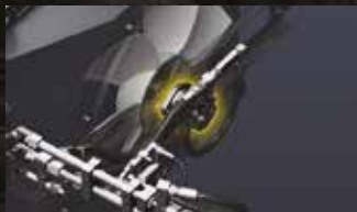
Вентилятор охлаждения для маслоохладителя
