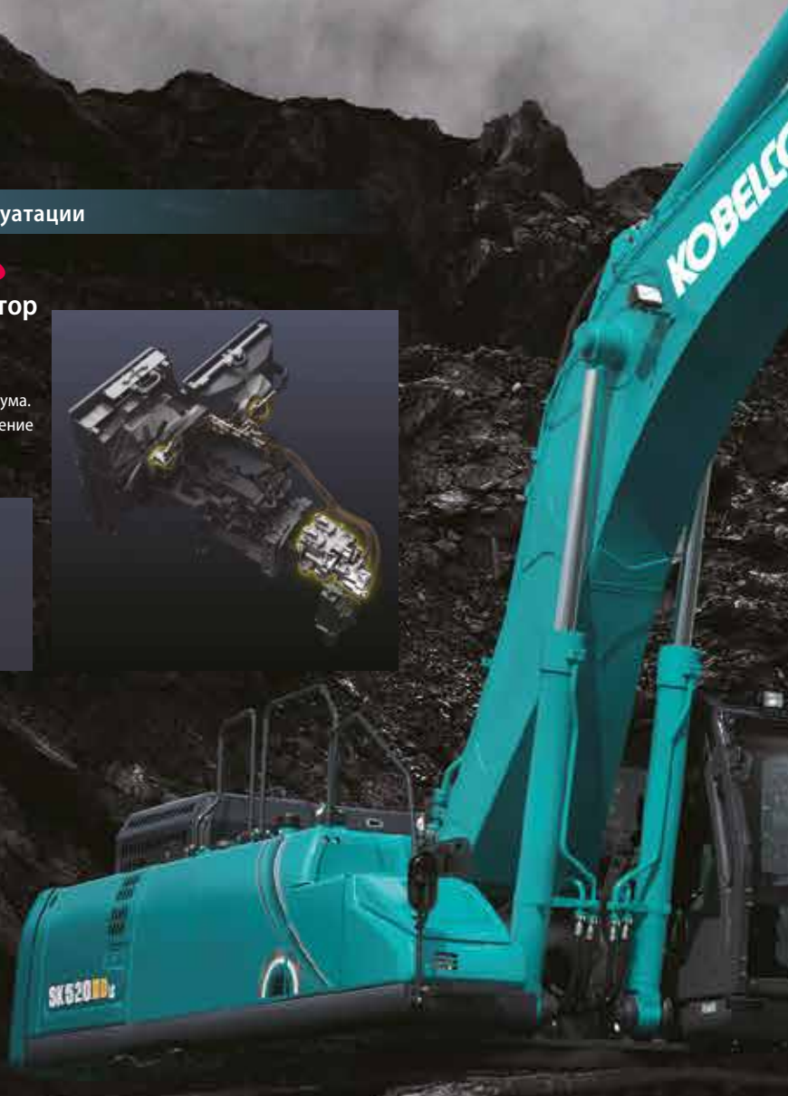
Вентилятор охлаждения для маслоохладителя
