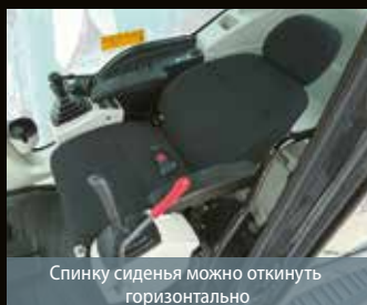
Сиденье с амортизирующей подвеской поглощает вибрацию
