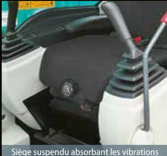
Siège suspendu absorbant les vibrations
