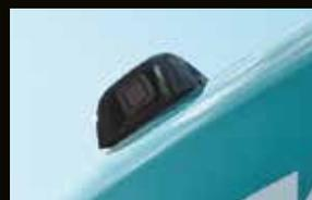
Une caméra de rétrovision peut être installée en option pour sécuriser l'arrière de la pelle d'un simple coup d'oeil sur le moniteur.
