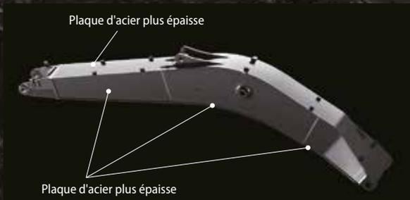
La flèche XD utilise des plaques plus robustes que les flèches HD des machines standard, ce qui augmente la longévité même dans les conditions de travail les plus rudes.
