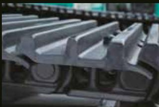
Les tuiles HD plus épaisses et les maillons de chaîne HD autolubrifiés résistent aux sols rocailleux les plus abrasifs.
