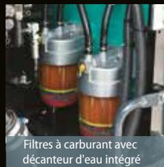
Filtres à carburant avec décanteur d'eau intégré
