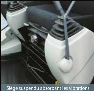
Siège suspendu absorbant les vibrations
