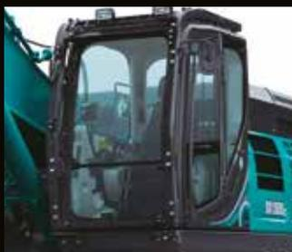
La cabine conforme ROPS (Roll-Over-Protective Structure) répond aux normes de cabine ISO (ISO-12117-2: 2008) et assure une meilleure sécurité du chauffeur en cas de basculement de la machine.
