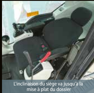
Siège suspendu absorbant les vibrations
