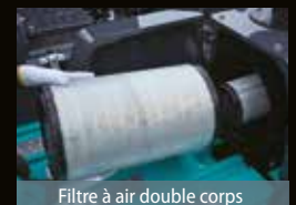
Filtre à air double corps
