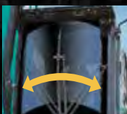
Essuie-glace à parallélogramme pour un balayage intégral
