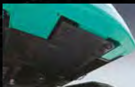
Verstärkte Schutzabdeckungen unter dem Oberwagen Die 6 mm dicke Stahlplatte schützt die Bauteile im Bagger.
