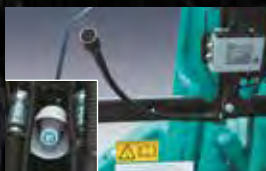
Lautsprecheranlage für Durchsagen Alarmieren der Mitarbeiter in der Umgebung mit klarer Audioqualität.
