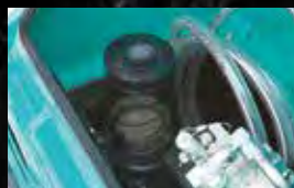
Automatisches Schmiersystem Schnelles Abschmieren der Anbaugeräte.
