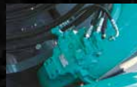
Sicherheitsventil für Ausleger- und Stielzylinder Verhindert, dass das Anbaugerät absinkt, falls ein Schlauch beschädigt wird.
