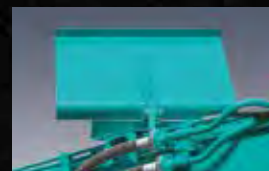
Abweiser gegen herabfallende Objekte Der Abweiser lenkt herabfallende Trümmer von der Maschine ab. Dies ist Standard für die ultra-lange Arbeitsausrüstung.
