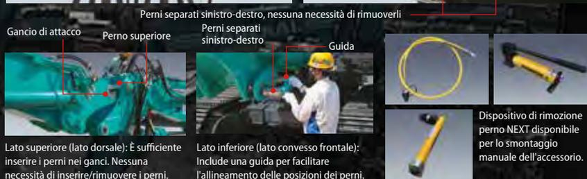
Lato superiore (lato dorsale): È sufficiente inserire i perni nei ganci. Nessuna necessità di inserire/rimuovere i perni.
