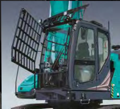
Eenvoudig te openen en reinigen cabinebescherming (bovenkant voorruit en dakraam)
