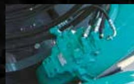
Válvula de seguridad del balancín, el brazo y el cilindro del aguilón. Impide que el implemento caiga si se rompen los conductos.
