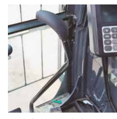
Levier de commande de l'articulation de flèche primaire de l'équipement en 4 éléments
