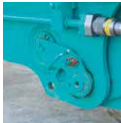
Separate gegenüberliegende Bolzen links und rechts
