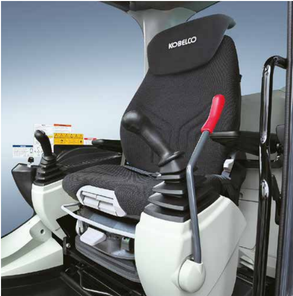
Luftgefederter Sitz mit Rücken- und Nackenstütze reduziert Ermüdungserscheinungen
