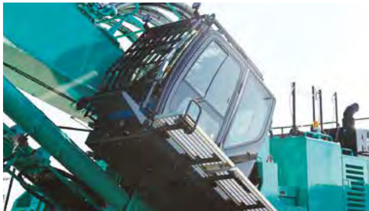
De cabine kan 30 graden kantelen. Dit zorgt voor een optimale kijkpositie wanneer er lange tijd achtereen op hoogte moet worden gewerkt.
