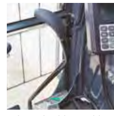
Bedieningshendel voor 4-delig extra lang uitrustingsstuk in voertuimte.
