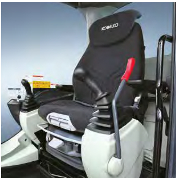
Luchtgeveerde stoel met ondersteunende rugleuning en neksteun vermindert vermoeidheid.
