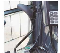
Palanca de control de la máquina con especificación de demolición de alcance elevado situada en la zona de los pies
