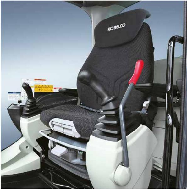
El asiento con suspensión neumática, respaldo sostenedor y reposacabezas reduce la fatiga
