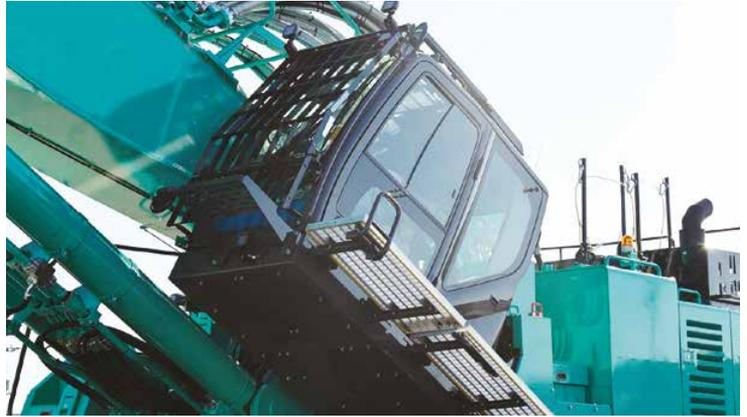
El ángulo de inclinación de la cabina de 30 grados ofrece la posición de observación óptima cuando la aplicación exige largos períodos de trabajo en altura.
