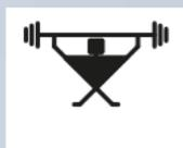
En activant la fonction levage lourd, les pompes hydrauliques délivrent plus de pression et légèrement moins de débit pour plus d'efficacité et de précision lors des phases de manutention délicate.
