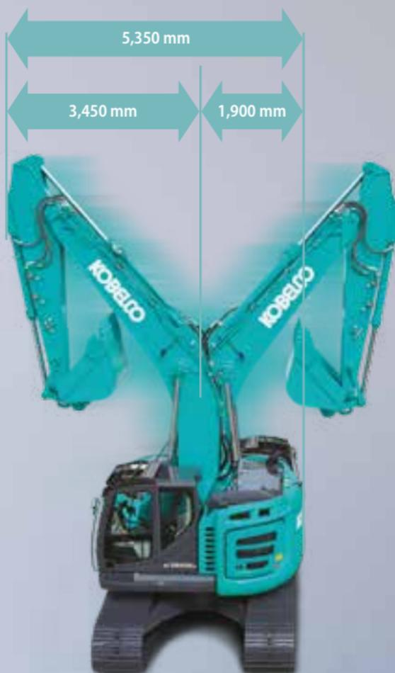
En plus d'excellentes performances de levage et d'excavation, la SK380SRLC est équipée en standard usine de toutes les lignes hydrauliques pour recevoir tous les équipements disponibles sur le marché, système de guidage inclus. Sa compacité est particulièrement appréciée pour les grands travaux routiers, d'assainissement, de démolition et les gros travaux de terrassement en agglomération. De plus, la cabine permet au chauffeur de se concentrer sur le travail dans un espace large et confortable.
