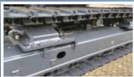
La anchura de la oruga se puede ajustar mediante las posiciones del perno de fijación para cumplir con las regulaciones de transporte.
